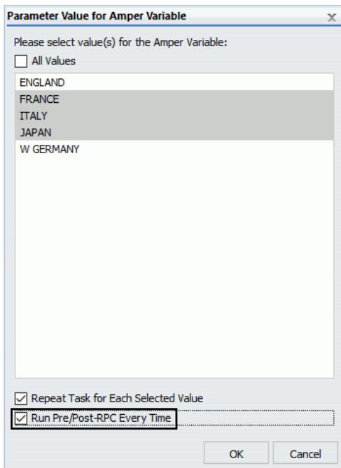
[実行前/実行後プロシジャを毎回実行] チェックボックスを使用して、Distribution Server は、タスクの繰り返し実行で実行前および実行後プロシジャを毎回実行することができます。
